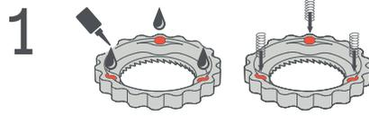
Befülle die Löcher mit acros Nabenfett und setze die Federn ein.
